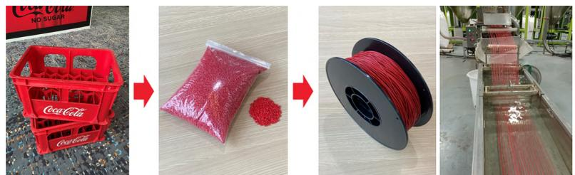
可回收玻璃瓶箱的造粒流程
