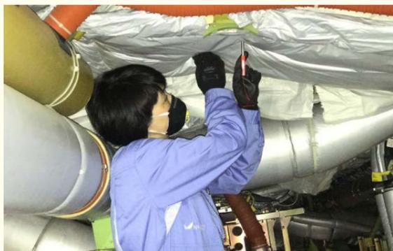
厦门太古的工程师使用创新工具引孔器进行机舱内作业。
